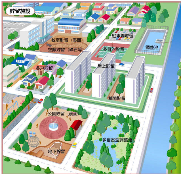
図3 雨水貯留施設の種類
