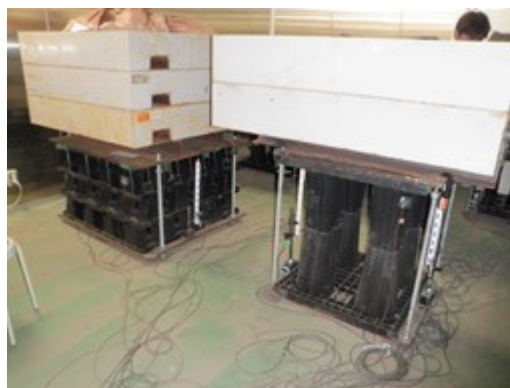
図附 2.1 鉛直方向の長期クリープ試験における試験体イメージ
