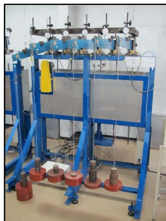
図附 4.2 引張クリープ試験装置概要図
