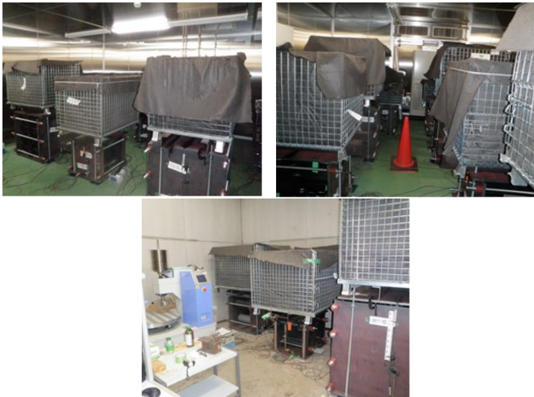
図附 2.2 水平方向の長期クリープ試験における試験体イメージ
