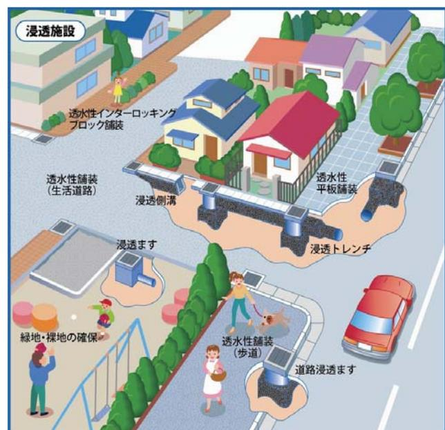
図2 雨水浸透施設の種類
