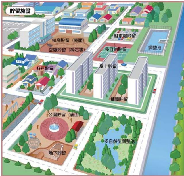
図3 雨水貯留施設の種類
