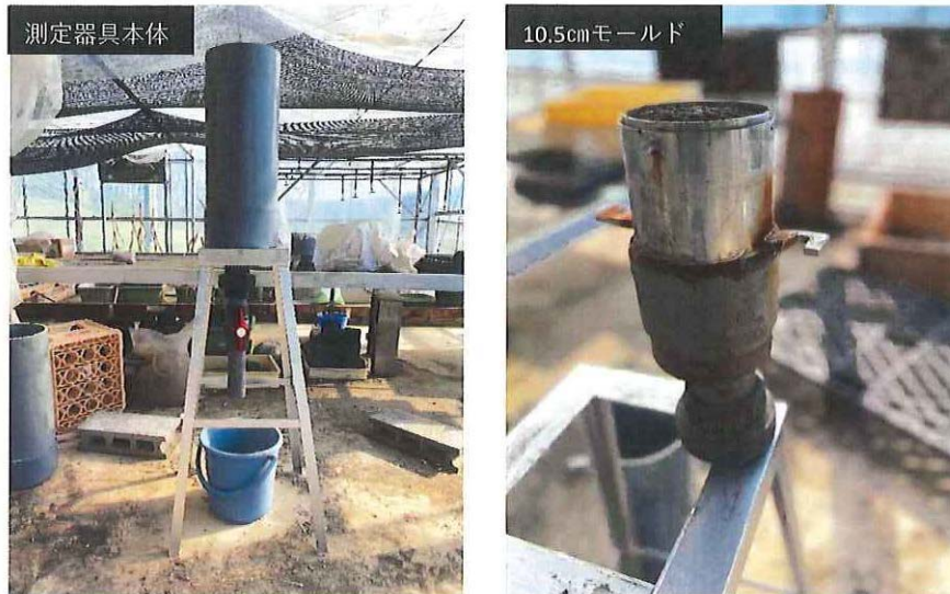
写真1 エコロベースソイル CA プラス目詰まり促進試験器具
