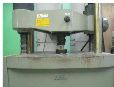
圧縮強度試験状況
