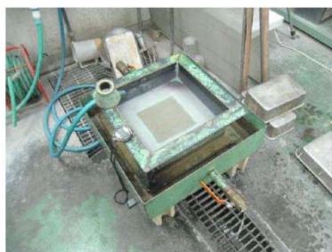
透水性試験状況
