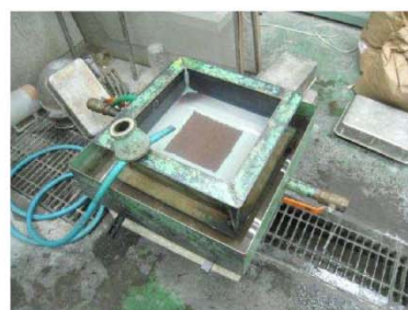
透水性試験状況
