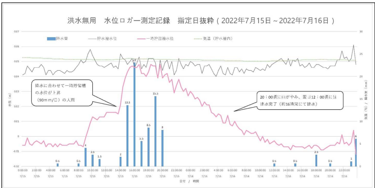
図3 本製品の実績降雨による排水時間検証結果
