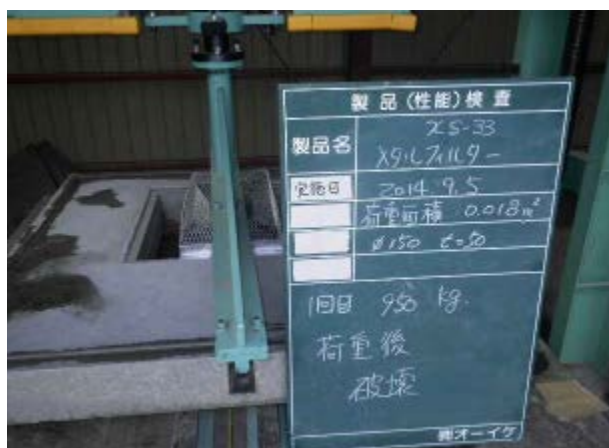
写真3 載荷重 9.6kN 時の状況
