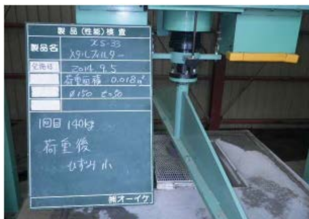
写真2 載荷重 1.4kN 時の状況
