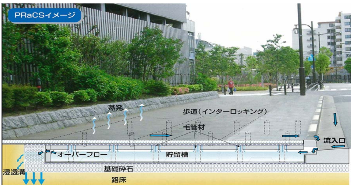
図1 プラックスの構造及び機能イメージ
