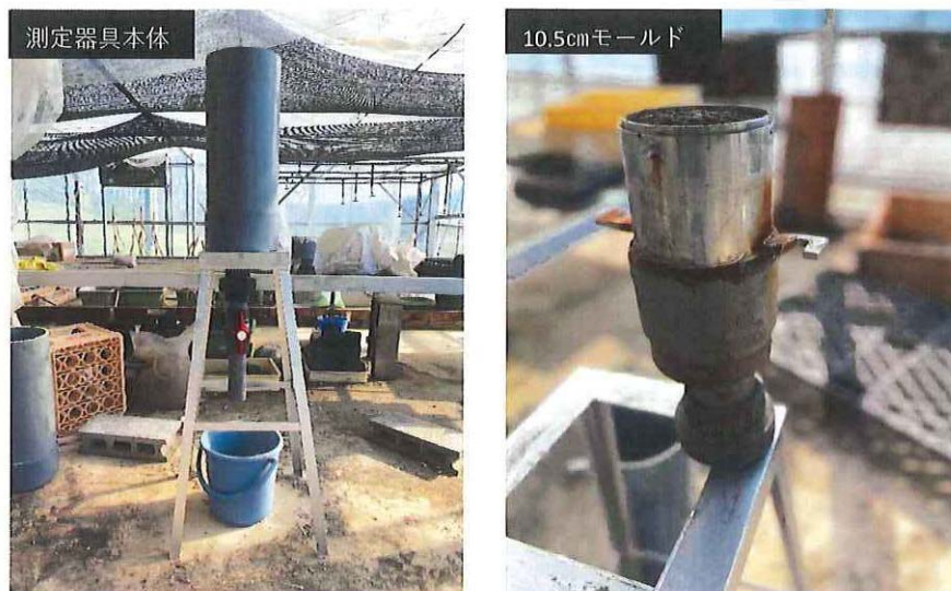
写真 1 エコロベースソイル CA プラス目詰まり促進試験器具
