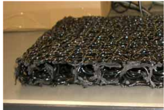
写真1 長期試験 ( v=50\text{kN/m}^2 、 A_s=600\text{cm}^2 )
