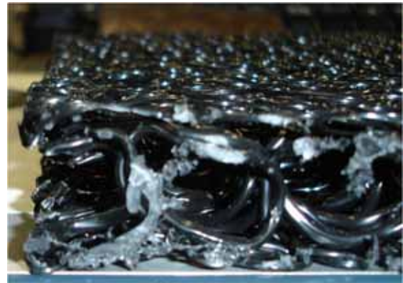
写真2 短期試験 ( v=100\text{kN/m}^2 、 A_s=600\text{cm}^2 )
