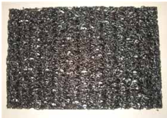
写真1 長期試験 ( v=50\text{kN/m}^2 、 A_s=600\text{cm}^2 )
