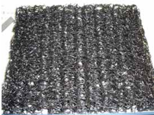
写真2 短期試験 ( v=100\text{kN/m}^2 、 A_s=600\text{cm}^2 )
