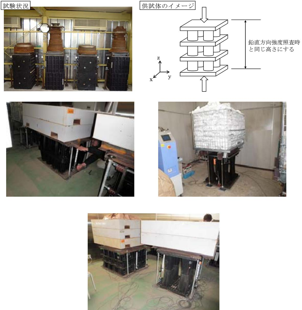
図附 2.1 鉛直方向の長期クリープ試験における試験体イメージ
