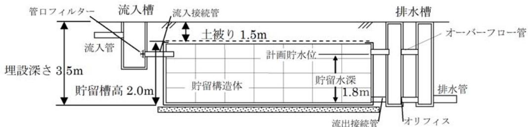
図資 6.4 土被り・貯留槽高・埋設深さの決定
