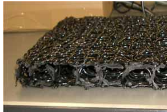
写真1 長期試験 ( v=50\text{kN/m}^2 、 As=600\text{cm}^2 )
