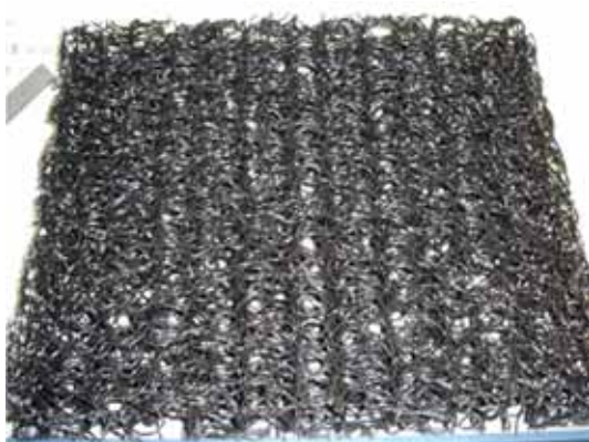
写真2 短期試験 ( v=100\text{kN/m}^2 、 As=600\text{cm}^2 )
