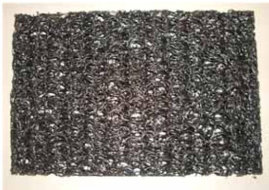
写真1 長期試験 ( v=50\text{kN/m}^2 、 As=600\text{cm}^2 )
