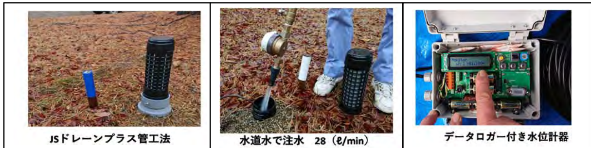
写真1 長岡技術科学大学構内の浸透試験装置（令和元年12月3日実施）
