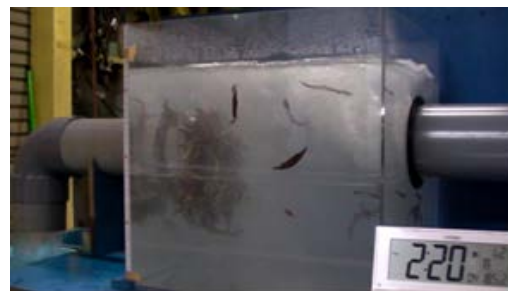
写真3 ゴミの付着状況（沈むゴミ）
