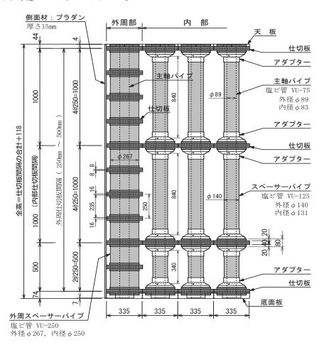
図1 アクアパレス槽の基本構造図
